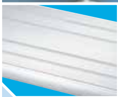
← Steg av räfflad aluminiumprofil (standard). Stegdyp 175 mm vid 60° och 225 mm vid 45°. Halkskydd enligt DIN 51130:R10.
