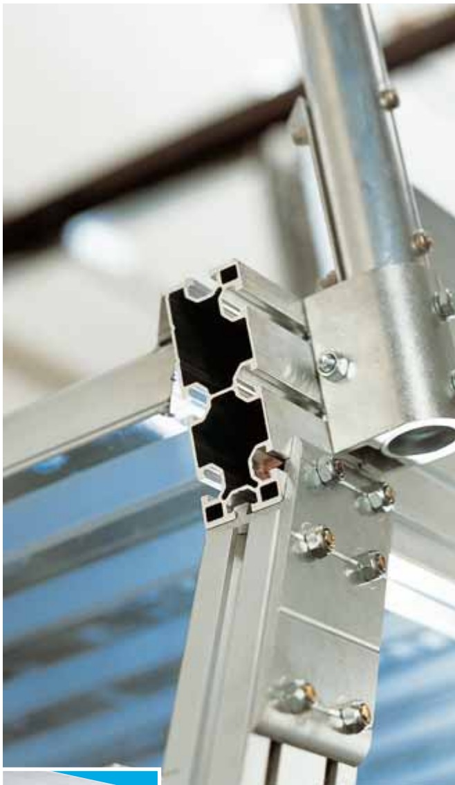
← Steg av räfflad aluminiumprofil (standard). Stegdyp 175 mm vid 60° och 225 mm vid 45°. Halkskydd enligt DIN 51130:R10.
