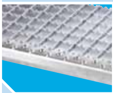
← Steg av stål-galler. Stegdyp 185 mm vid 60° och 240 mm vid 45°. Halkskydd enligt DIN 51130:R12. (erhålls mot extra kostnad)
